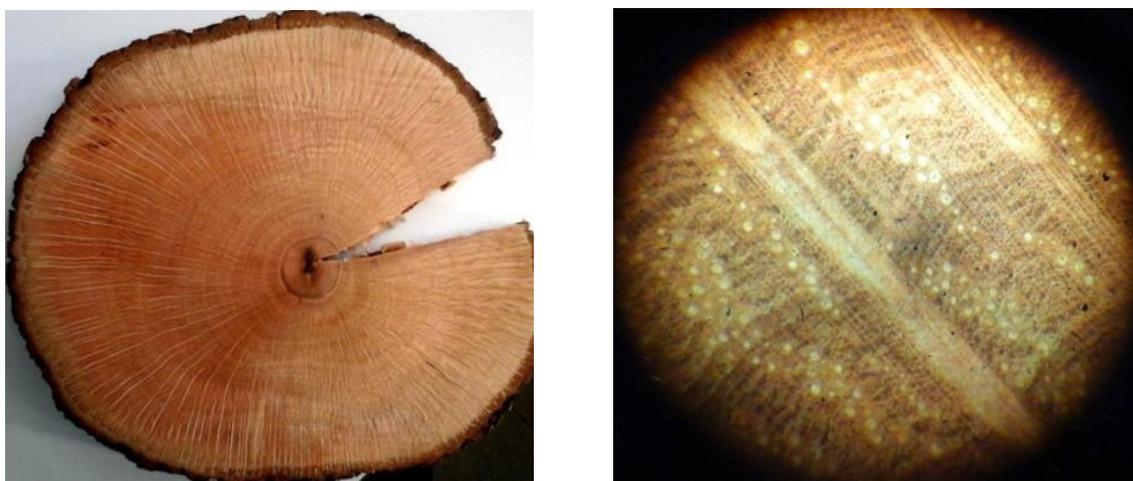
Figura 1.2. Ejemplo de una muestra en la que se puede apreciar la diferencia del color y del tamaño de los elementos vasos en la madera temprana y la madera tardía.
