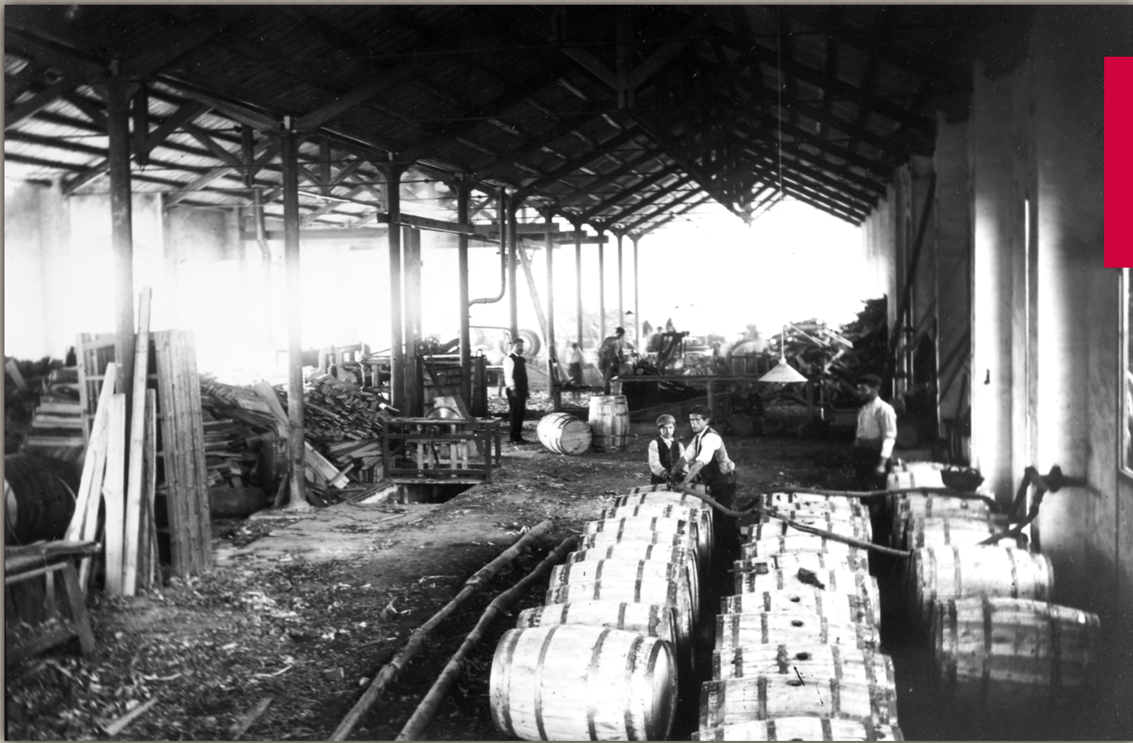
Interior d'una fàbrica de bótes de finals del segle XIX, inici del XX. Al fons s'observa les serradores que transformaven les perxes en dogues i en primer pla dos nens amb una mànega per netejar la bóta.
