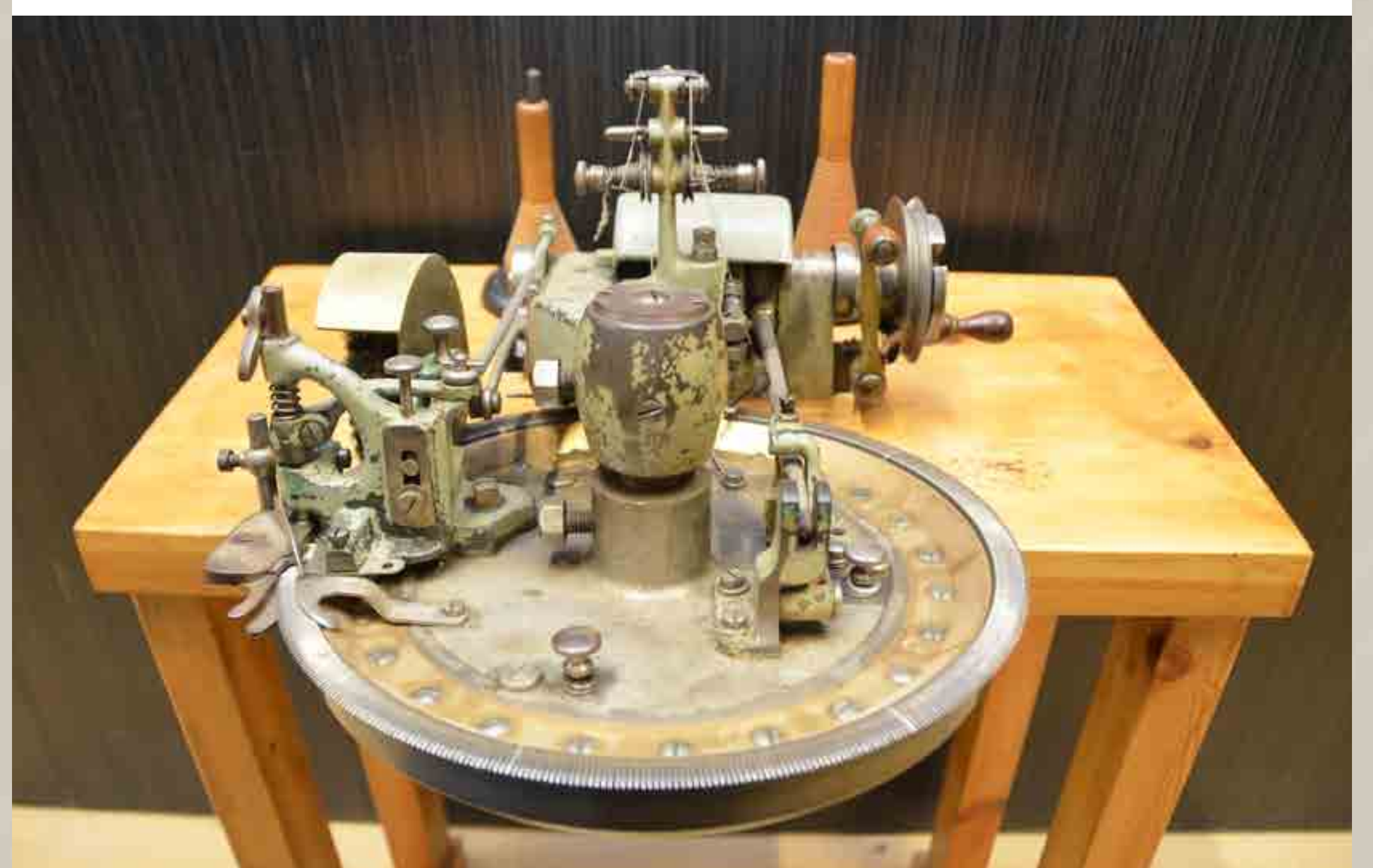
Imatge d'una remallosa, que servia per fer els acabats dels mitjons. Sovint també s'emprava en el treball domèstic.
