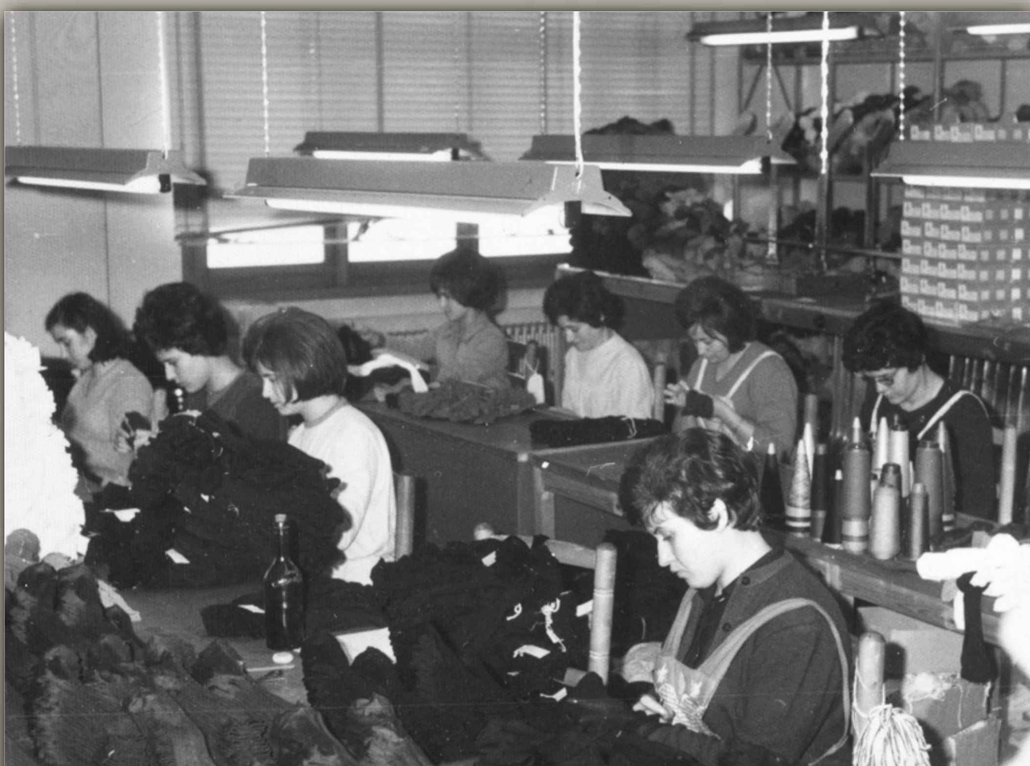
Repassadores de Ca l'Albert a finals dels anys 1950. Al fons a la dreta s'observen sirvits, plataformes de vapor que s'utilitzaven per planxar el mitjà i donar-li la seva forma característica.
